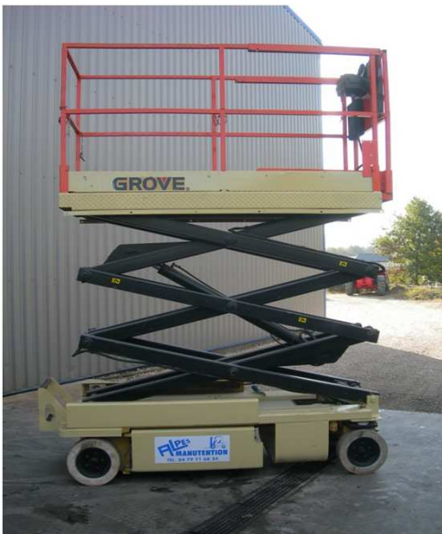
Nacelle ciseau électrique GROVE 2632E Hauteur de travail 8,10 m Plateforme : 2,22 x 0,81 m + extension 0,90 m Année : 1999
